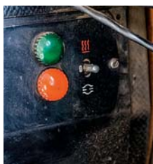
В моторном отсеке – отдельный пульт пуска двигателя.
