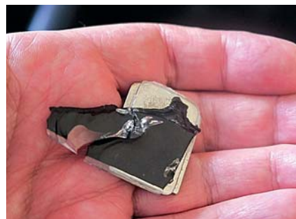
Пластины, которые покинули рабочее место с кусками стекла, явно держались лучше «чистеньких».
