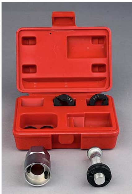
Специальная разрезная плашка для восстановления захода резьбы.
