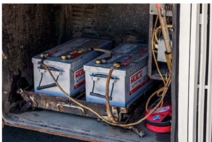
Аккумуляторы выдвигаются на специальных полозьях. Удобно!
